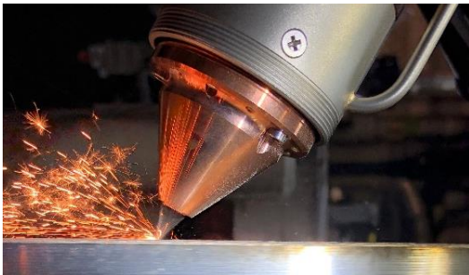
Abbildung 2: Extremes Hochgeschwindigkeits-Laserstrahl-Auftragschweißen (EHLA) mit einer HighNo-Pulverzufuhrdüse unter 30°
